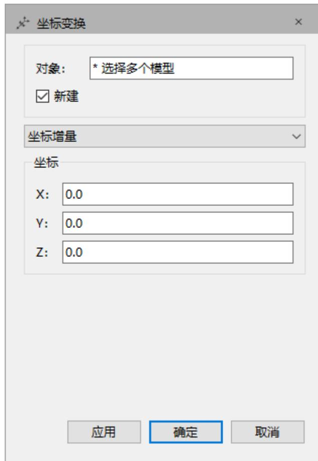
图 2-174 “坐标变换”（类型 4）对话框
